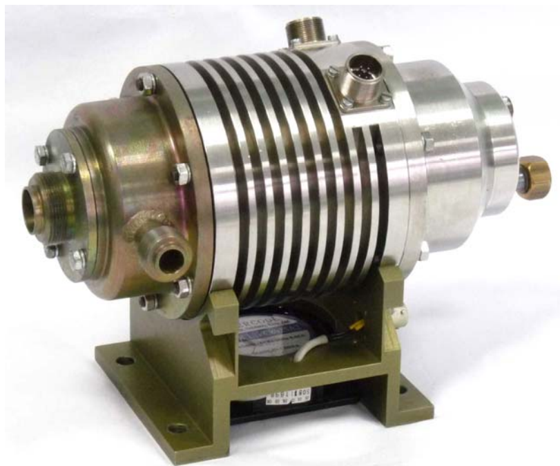
Рис. 7. Внешний вид высокооборотного фреонового турбогенератора ТГ-1 на лепестковых газодинамических подшипниках.
