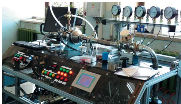
Рис. 4. Общий вид стенда для обкатки и воздушных испытаний ТД
