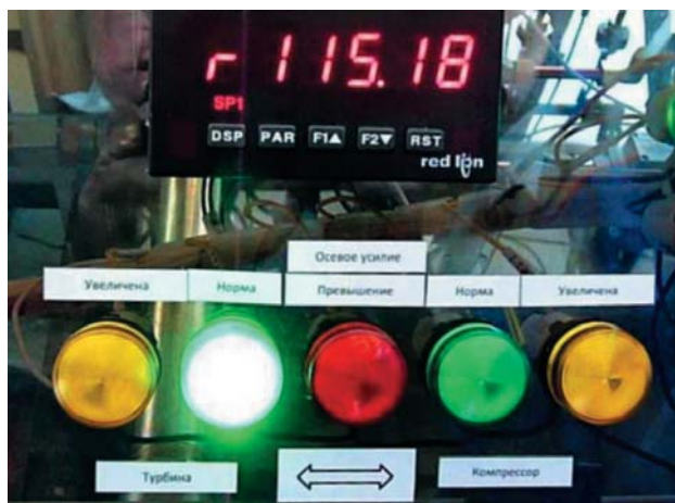
Рис. 2. Фрагмент панели управления стенда с индикатором частоты вращения ротора ТД и табло контроля осевого усилия на подпятники
